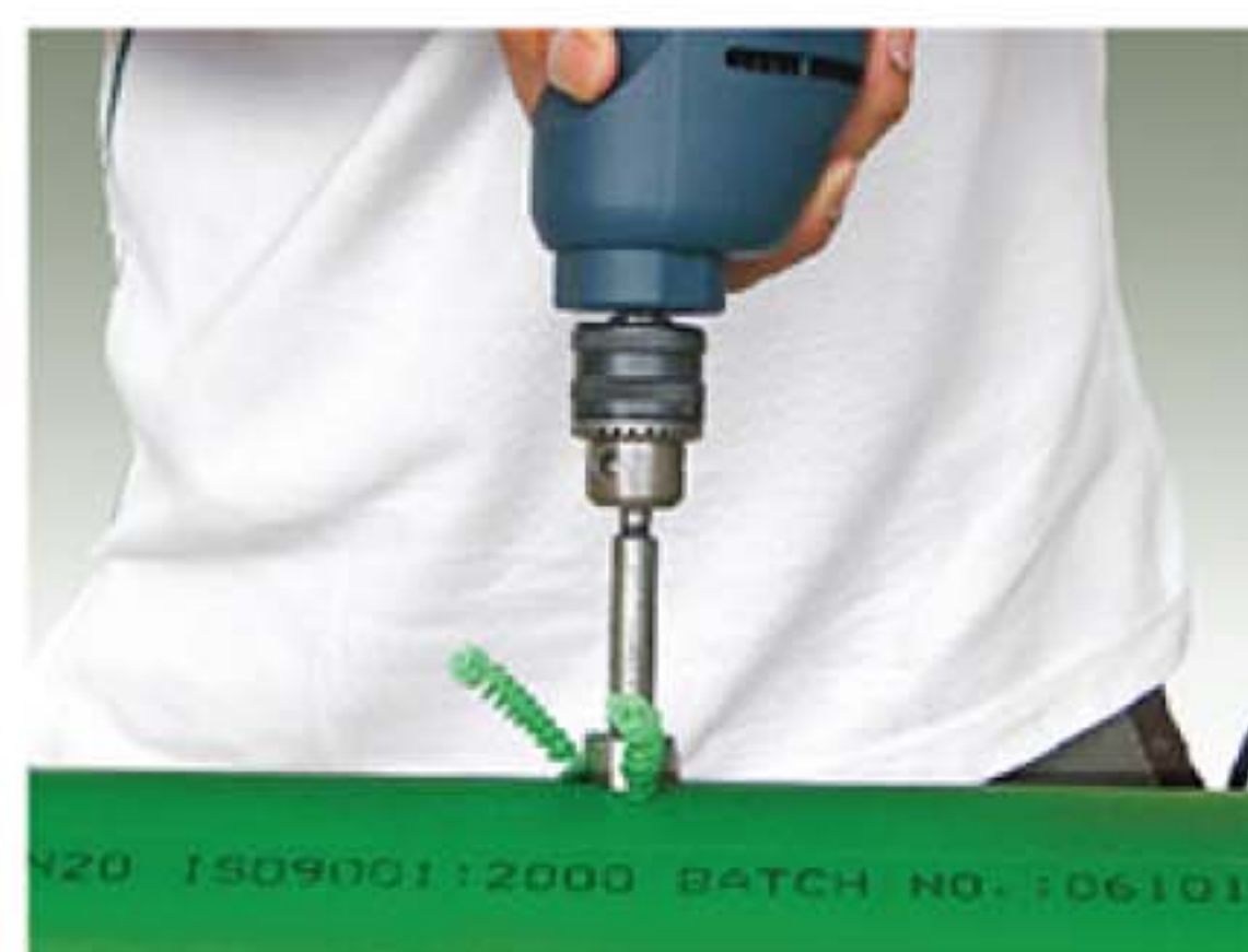
วิธีเจาะและเชื่อมต่ออานม้า
